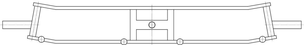
(So nicht zugelassen, da sich "mehr als EIN Drehpunkt" auf der horizontalen Ebene befindet!)
